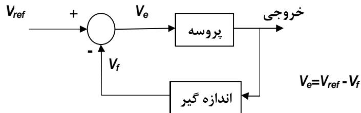
**مثال ۱)** در سیستم زیر یک فرآیند کنترل دمای محصول داخل دیگ مشاهده می شود. در این سیستم ورودی میزان دمای مطلوب داخل دیگ است و خروجی دمایی است که در هر لحظه توسط ترموموکوپل اندازه گیری می شود و نمایش داده می شود. مبدل حرارتی عمل انتقال حرارت را از بخار داخل خود به محصول گیری می دهد. و دبی بخار عبوری از مبدل حرارتی توسط شیر کنترل می شود. میزان باز یا بسته بودن شیر به محرك تنظیم می شود و سیگنال کنترلی است که از خروجی تقویت کننده بدست می آید.
