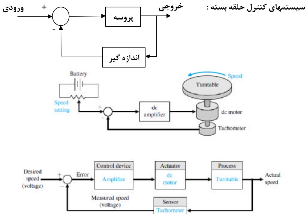
در شکل فوق سیستم کنترل سرعت موتور  $dc$  دیده می شود که برای ثبیت سرعت موتور در حالت بارداری و بی باری از تاکومتر برای اندازه گیری سرعت و فیدبک آن به ورودی استفاده شده است.
