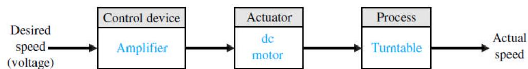
در سیستمهای کنترل حلقه باز هیچ فیدبکی از خروجی به ورودی داده نمی‌شود.
