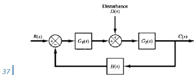
ملاحظه می شود که سیستم دارای یک خروجی و دو ورودی مرجع ( $R(S)$  و اغتشاش  $D(S)$ ) است. می دانیم که تابع تبدیل همواره نسبت یک خروجی به یک ورودی است. بنابراین در سیستمهای  $MIMO$  باید خروجیهای اضافی را غیرفعال کرد و ورودیهای اضافی را صفر کرد تا تابع تبدیل خروجی به ورودی مورد نظر بدست آید.
