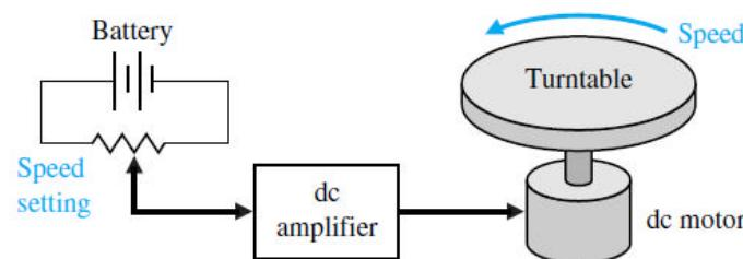
سیستم کنترل حلقه باز برای کنترل سرعت یک موتور *dc* به همراه بلوک دیاگرام آن
