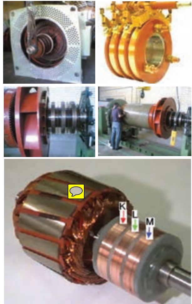
شکل ۸- رتور سیم‌پیچی شده در ابعاد مختلف
